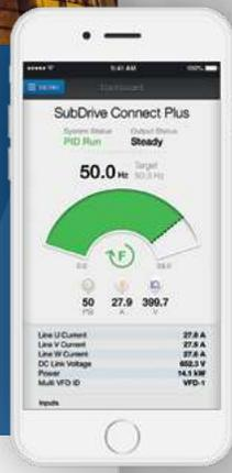
Inigualable por su facilidad de uso, el variador de frecuencia SubDrive Connect Plus™ está diseñado para proporcionar soluciones completas de presión constante para sistemas de bombeo de agua en una variedad de aplicaciones sumergibles que trabajan con motores trifásicos de hasta 30 HP.
