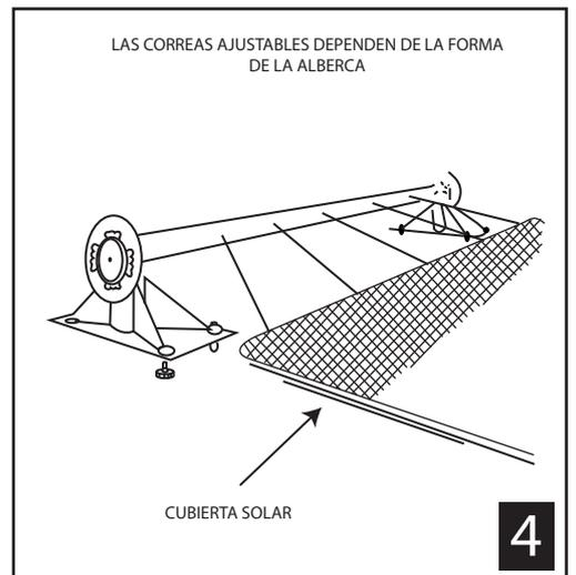
Cuando se instalan las correas a la cubierta solar estas deben estar en la misma distancia de las otras. La longitud de la correa debe ser ajustada en función a la forma de la alberca.
