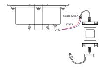
Localice las terminales de salida del transformador (12Vca) y conecte los dos cables de alimentación a su correspondiente tablilla de alimentación. Conecte los cables de el burbujeador a la tablilla de salida del transformador, puede colocarse en cualquier orden ya que no tiene polaridad. Asegúrese de que el interruptor de entrada se encuentre en la posición de APAGADO antes de la puesta en marcha. La unidad LED ya está lista para operar.
