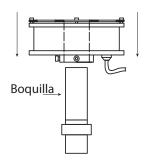
2. Coloque el orificio del burbujeador sobre la boquilla en la dirección de la flecha.
