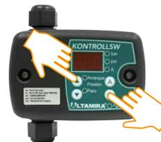
Vuelva a oprimir **OK** en ambos equipos para arrancar las bombas y con esto terminará de configurar su sistema DÚPLEX. Felicidades, usted acaba de configurar su sistema dúplex.
