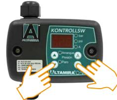
Oprima igual por 3 segundos **▲** hasta que parpadee el display y ajuste la presión de arranque, con los mismos botones ajuste el valor de presión de arranque deseada y luego oprima **OK** para guardar los cambios
