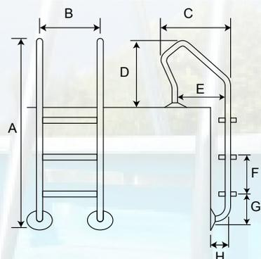
Escaleras fabricadas en acero inoxidable de 3 peldaños, para instalación en piscina con superficie de madera.
